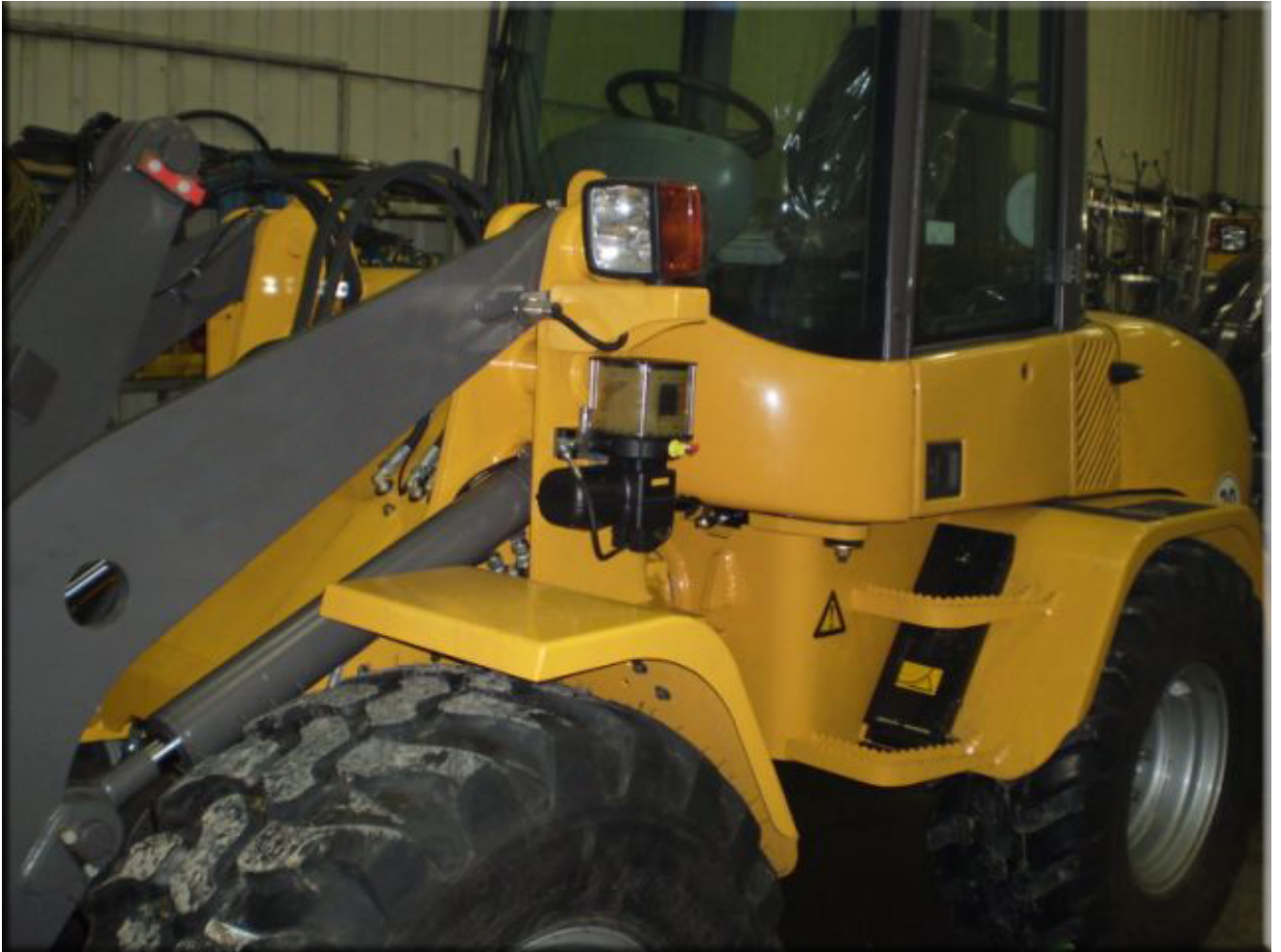
En esta cargadora con ruedas se monta una bomba ILC-MAX en la plataforma del operador o cerca de la cabina para facilitar el control
