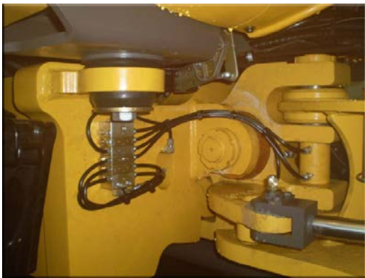
Los divisores progresivos ayudan a garantizar que el lubricante se distribuya por los rodamientos, los pasadores y los casquillos de alta demanda
